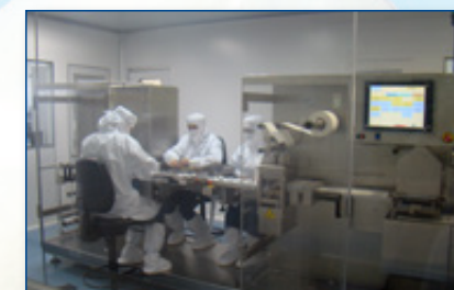
Clean Room / Sala Limpa: descontaminação, embalagem e esterilização. Padrão Internacional ANVISA, CE e FDA
